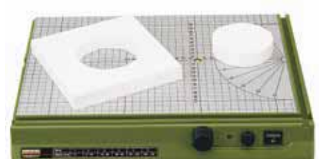
Para cortes circulares deve-se fixar uma das pontas da peça para servir como centro fixo.
